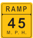
Velocidad recomendada en la rampa
